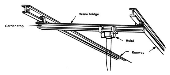
UNDERHUNG BRIDGE/UNDERHUNG TROLLEY
