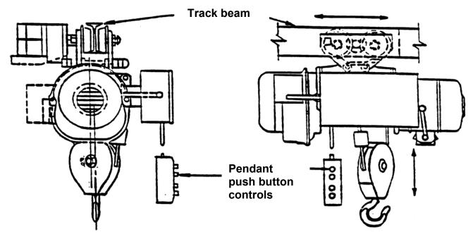
OVERHEAD HOIST TROLLEY-MOUNTED ON MONORAIL TRACK
