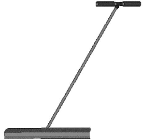
directamente al vástago. Si el vástago original está hecho de madera, esto significará reemplazarlo también por tubo. Utilice un vástago de tubo de  $3/4$ ". Al ser huecos, los tubos no contribuirán a que la raspadora sea demasiado pesada. Luego, envuelva los tramos con aislamiento de tubo de espuma para acolchonar el mango.
