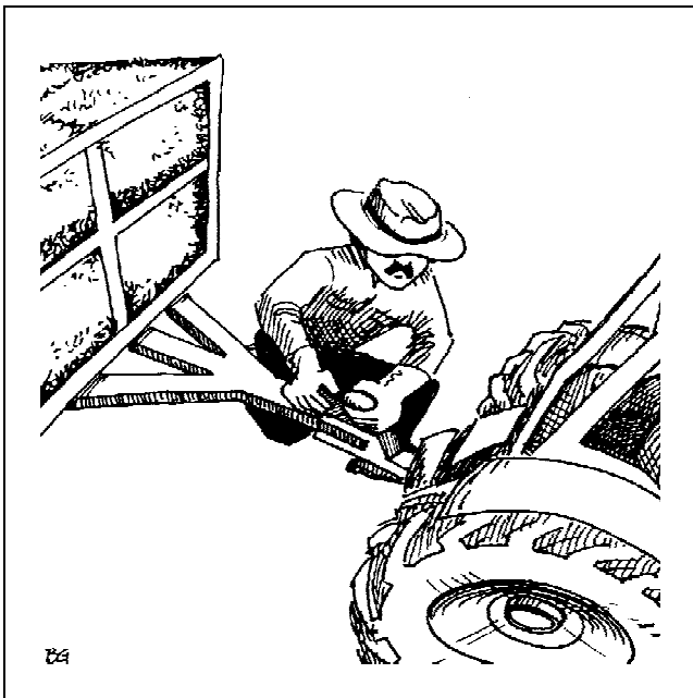
Figura 6. Enganche solamente en la barra de tracción y puntos de enganche
