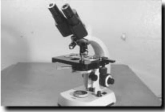
Debe estar equipado con una fuente de luz eléctrica o un espejo, un objetivo de aceite de inmersión de 100X, oculares con una magnificación de 8X ó 10X, y una platina mecánica.
