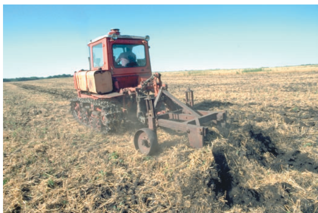
Фото 5-2. В Докучаевском научно-исследовательском институте сельского хозяйства Центрально-Черноземного региона ученые используют 2-х лемешный плуг (фото 5-3) и дисковую борону (фото 5-4) для подготовки пашни к осеннему севу. Оба метода оставляют почти 80% растительных остатков на поверхности почвы для борьбы с эрозией. (Фото Тима МакКейба)
